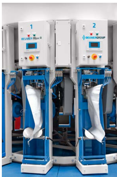
De roterende Beumer fillpac voor het vullen van zakken
